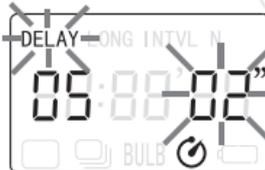
3、按[▶]鍵，進入延時拍攝的延時時間設置。此時延時拍攝時間圖標[DELAY]、延時拍攝時間[02]同時閃爍。
